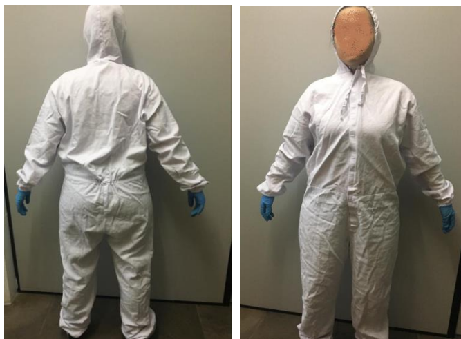
Imagem da vestimenta após ensaio de pulverização norma ISO 17491-2
